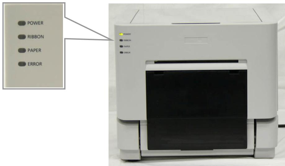
El parpadeo del LED indica el estado de la impresora
