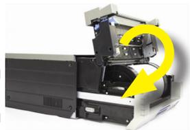
8. Tirer sur le papier de sorte que le papier se superpose à la partie supérieure du rouleau de papier et arrive dans l'imprimante au niveau du bord avant du compartiment à papier. L'imprimante émet un signal sonore lorsque le papier est inséré correctement.
