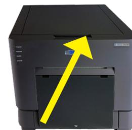
4. **Charger le papier.** Chargez le papier sur les bobines de papier (sans laisser d'espace). Placez la bobine chargée dans l'imprimante de sorte que le bord avant du papier se charge au-dessus du rouleau, vers l'avant de l'imprimante.
