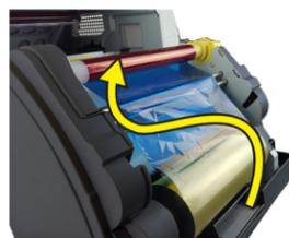
6. **Charger le ruban dans l'imprimante.** Chargez d'abord le côté gauche de la bobine dans le support, puis enclenchez le côté droit à sa place. Réglez le côté d'alimentation (les deux extrémités blanches) dans les supports inférieurs (à l'avant). Déposez le côté récepteur (une extrémité blanche et une autre jaune) dans les supports supérieurs (à l'arrière).
