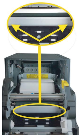
9. Réglez le ruban du côté de la bobine d'alimentation (les deux extrémités blanches) dans les supports inférieur ou frontal. Déposez le côté récepteur (une extrémité blanche et une autre jaune) dans les encoches supérieures ou dans celles placées à l'arrière. Mettez d'abord le côté gauche de la bobine à ruban en place, puis enclenchez le côté droit de la bobine.
