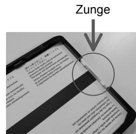
Entnehmen Sie das Druckpapier aus der Verpackung einschließlich der Schutzblätter und legen Sie es in das Eingabefach. Legen Sie das Papier so ein, dass sich der Rand unterhalb der Zunge des Papieranschlags befindet.
