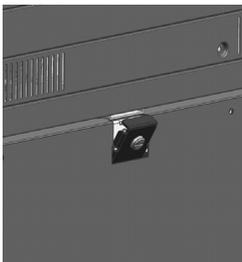
Vérifiez que les broches de guidage sur les deux côtés sont insérées dans les fentes en bas de l'imprimante.
