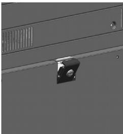
Compruebe que los pasadores de guía de ambos lados estén insertados en los orificios de la parte inferior de la impresora.
