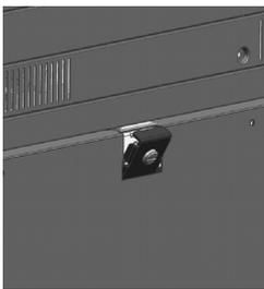
Stellen Sie sicher, dass die Führungsstifte auf beiden Seiten in die Löcher an der Unterseite des Druckers eingeführt sind.
