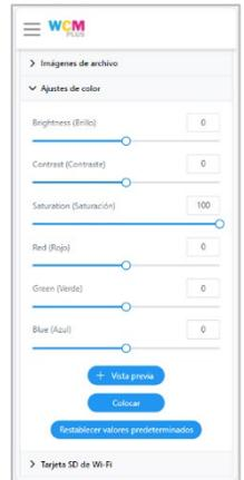
**WiFi SD Card (Tarjeta SD Wi-Fi):** para las cámaras que no puedan conectarse al punto de acceso WCM-Plus y no admitan transmisiones FTP, se puede utilizar una tarjeta SD con Wi-Fi (EZ Share®). Las cámaras capaces de utilizar una tarjeta SD Wi-Fi (EZ Share® es actualmente el único formato compatible) pueden conectarse al WCM para imprimir imágenes fácilmente. Esto puede ser útil para cámaras DSLR y Mirrorless que necesitan la capacidad de imprimir imágenes.
