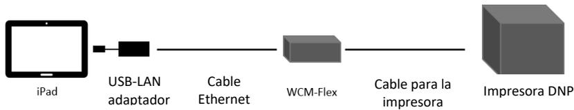
*Nota: Este método de impresión es para transferir archivos (FTP) a través de una conexión LAN por cable y no se utiliza para la conectividad a Internet.*
