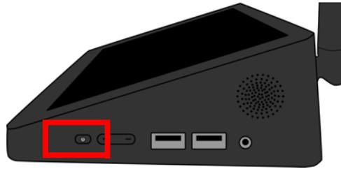
5. Lorsque le périphérique WPS Pro s'allume, il détecte automatiquement les imprimantes connectées et le support chargé dans ces imprimantes. Patientez trois minutes avant d'essayer de connecter des périphériques d'entrée au réseau du périphérique WPS Pro. Lorsque le périphérique WPS Pro s'allume, son écran tactile affiche le processus de démarrage et la durée restante avant que le périphérique WPS Pro ne soit fonctionnel.
